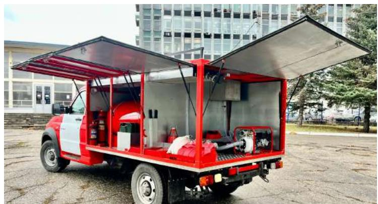
Последняя особенно эффективна при разливах горючих жидкостей! Высота подъема жидкости достигает 65 метров, а производительность - впечатляющие 650 литров в минуту.
