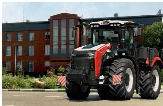
Производительность гидравлики – более 400 л/мин., что на треть превышает предыдущие показатели, имеются 6 гидравлических секций для прицепных орудий и заднее навесное устройство для навесных и полунавесных орудий. Тракторы отличаются экономным расходом топлива, высокие тяговые свойства при агрегатировании широкозахватными орудиями, что позволит хозяйствам оптимизировать структуру тракторного парка.
