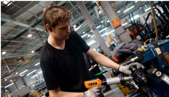
**Сборкой грузовых автомобилей «Урал» на главном конвейере теперь управляет «умное» оборудование. Ключи для затяжки резьбовых соединений позволяют выполнять прежде трудоемкие операции за считанные минуты.**
