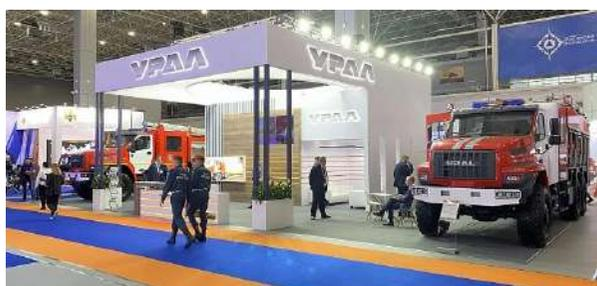
В частности, внимание министра привлекла пожарная автолестница на базе шасси «Урал-С3510» бескапотной компоновки с колесной формулой 6x4 с максимальной рабочей высотой подъема лестницы – 52 м. Дело в том, что подобных автолестниц отечественного производства практически нет, существуют только зарубежные аналоги. Также министр детально осмотрел полноприводную пожарную автоцистерну на базе шасси «Урал-4320-74» (АЦ 4,0-70) – производства миасского предприятия «УРАЛПОЖЗАЩИТА».
